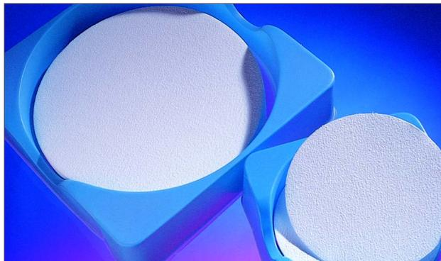
Ces filtres traités à l'acide à faible teneur en métal sont disponibles dans les diamètres 47 mm, 90 mm, 110 mm, 125 mm, 142 mm et 150 mm. Le filtre 90 mm est préconisé pour les échantillons volatils et employé en relation avec un extracteur ZHE. Le filtre 142 mm est communément utilisé pour les échantillons non-volatils dans un système homologué.
