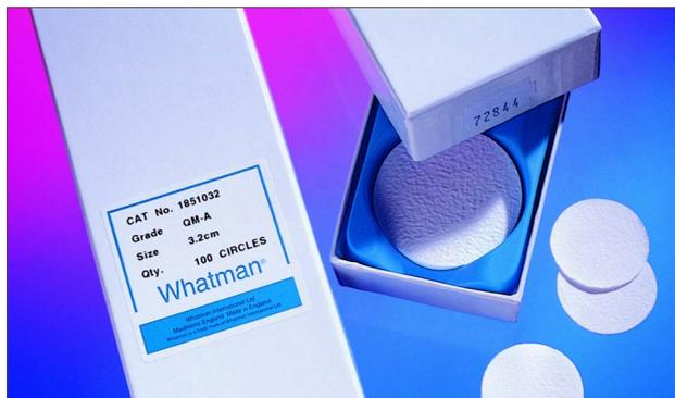
Le filtre EPM 2000 Whatman a été sélectionné par l'EPA comme filtre standard dans le réseau national d'échantillonneur d'air HiVol. Les feuilles sont numérotées individuellement pour faciliter leur identification.
