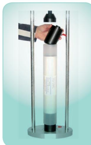
Mise en place finale de l'embout supérieur avec son joint et compression manuelle de la colonne grâce au volant
